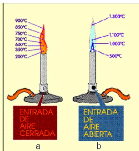
Fig. 4 a) se observa un ennegrecimiento producido por el depósito de carbón; b) combustión completa del gas a dióxido de carbono y agua.
