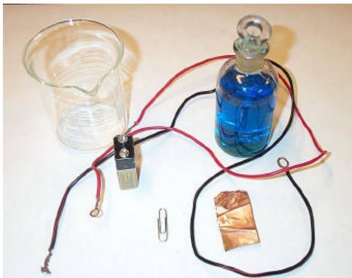
Figura 1. *Materiales necesarios: pila, cables, objeto a recubrir, lámina de cobre, vaso de precipitados y disolución 1,0 M de sulfato de cobre, CuSO<sub>4</sub>.*
