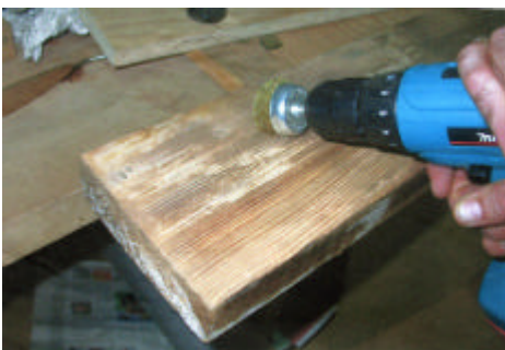
Figura 5. Cepillado de la madera.
