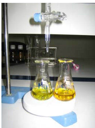
Figura 2 (izquierda). Matraces Erlenmeyer de la muestra y el blanco antes de la valoración.
