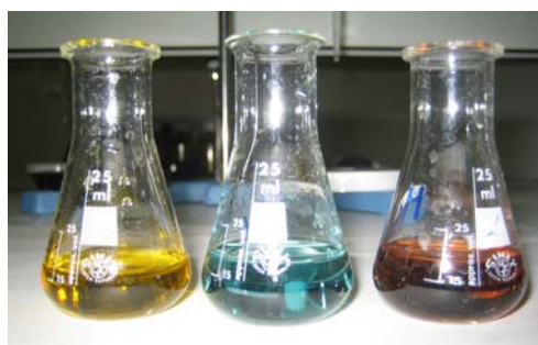
Fig 3 (derecha. Cambios de color durante la valoración. El punto final se corresponde con la coloración rojo teja.
