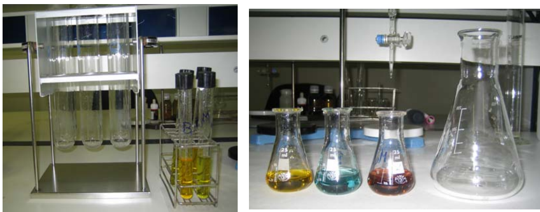
Figura 1. Comparación de tamaños de los matraces y de los tubos de digestión del método de reflujo (en base soporte) y de los del método micro (en gradilla).
