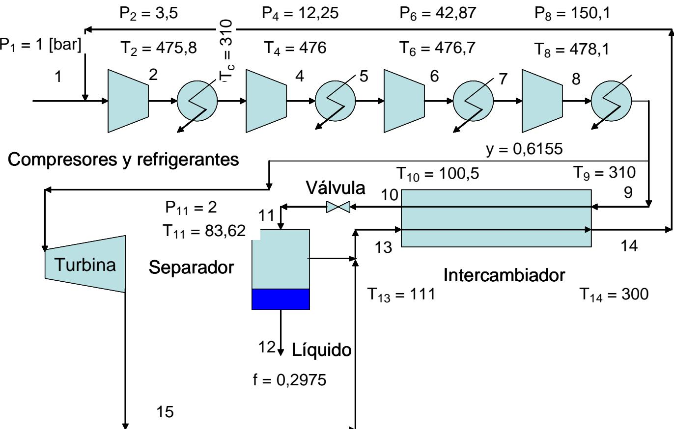
Obtención de nitrógeno líquido a partir de nitrógeno gas a temperatura ambiente por el proceso mixto Linde-Claude.
