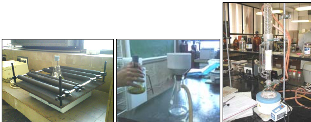
De izquierda a derecha: Figuras 9 y 10. Extracción en una etapa por agitación con hexano en un agitador orbital filtrado a vacío para obtener la disolución de cera. Figura 11. Extracción con equipo soxhlet
