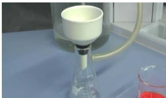
Figura 4. Filmación de la filtración al vacío.
