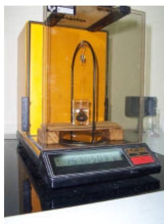
Figura 2. Esquema de la balanza y balanza usada para determinar W_a , W_w y W_m .
