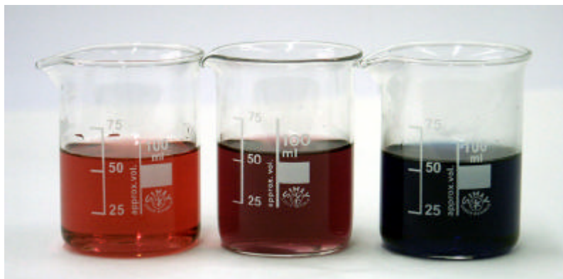
Figura 2. Efecto de la temperatura. En el centro una mezcla de hexacuocobalto(II) y tetraclorocobaltato(II) a temperatura ambiente. A la izquierda desplazamiento del equilibrio a 0° C y a la derecha a 100° C.
